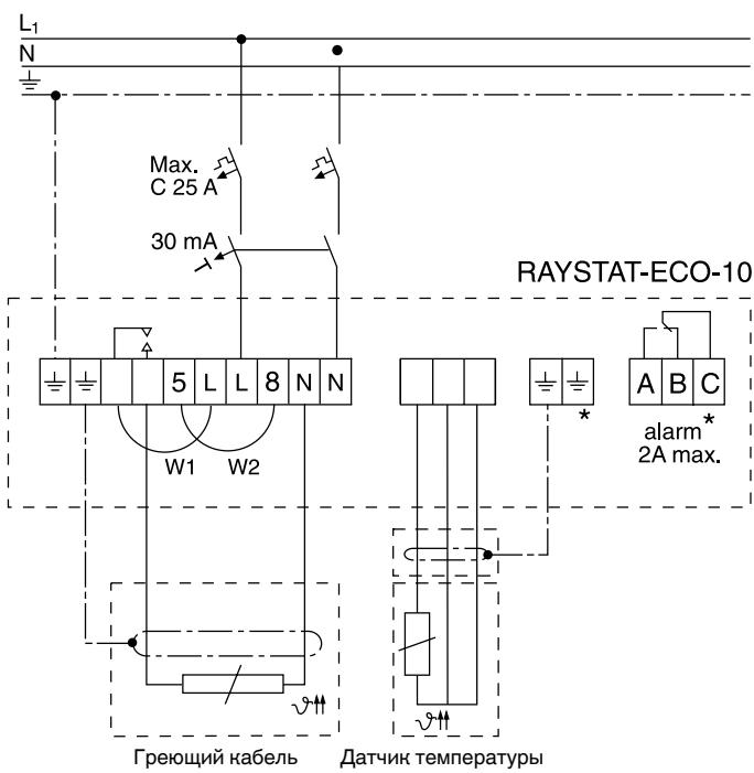
Работа без напряжения: удалить связи W1 и W2
