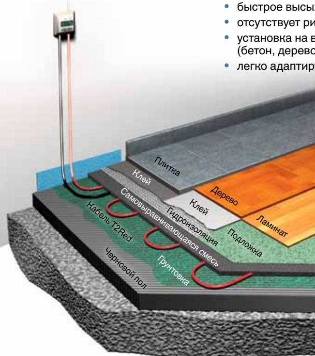
Кабель самостоятельно изменяет теплоотдачу в зависимости от внешних условий (температуры).
