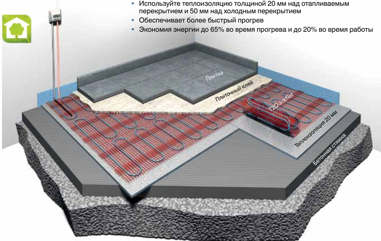
Использование слоя теплоизоляции (при новом строительстве или реконструкции) позволяет существенно повысить энергоэффективность системы:
