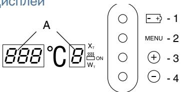
А. Жидкокристаллический дисплей (индикация параметров и ошибок)
