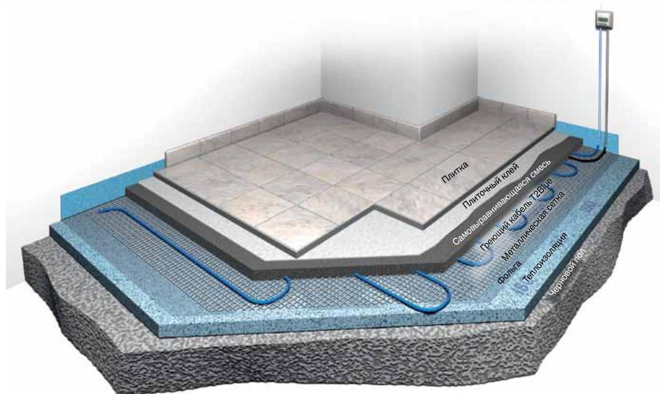
CeraPro: греющая секция для устройства теплого пола минимальной высоты
