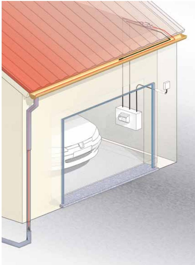
В дренажних каналах слід заглиблювати кабель як мінімум на глибину промерзання ґрунта (може варіюватися в різних регіонах)
